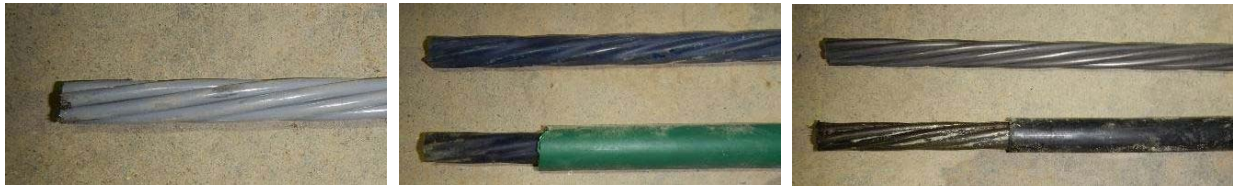
写真-2 供試体テンドン (左: アンカーA 中央: アンカーB 右: アンカーC)
