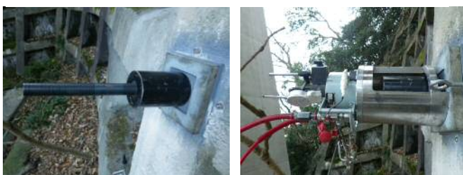
図 6. リフトオフ試験用の小型軽量ジャッキの設置状況
