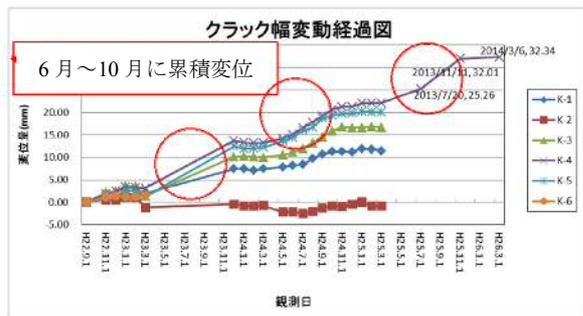
図 18 吹付工のクラック幅の経年変化
