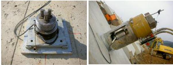
写真3 後付け荷重計(ナットゲージ)と設置状況
